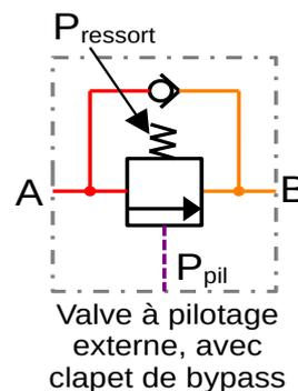
Il est à noter qu'un **limiteur de pression ne peut pas remplacer une valve de séquence**. La pression du côté aval (B) de la séquence peut être élevée, et la partie côté boîte à ressort n'est généralement pas conçue pour résister à de fortes pressions.
