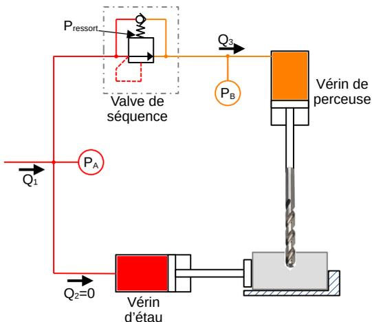
Lorsque la bride arrive en butée contre la pièce, la pression  $P_A$  augmente : la pièce est fermement maintenue en place. Une fois que la pression  $P_A$  dépasse la valeur du tarage de la séquence de mouvement ( $P_A = P_{\text{ressort}}$ ), la valve de séquence s'ouvre, et permet le passage du débit  $Q_1$  vers le vérin de perceuse ( $Q_3 = Q_1$ ). La mèche peut alors avancer pour percer la pièce.
