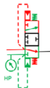
AVEC LA HP SUR LA LIGNE VERTE (FUITE SUR LA BP ROUGE)
