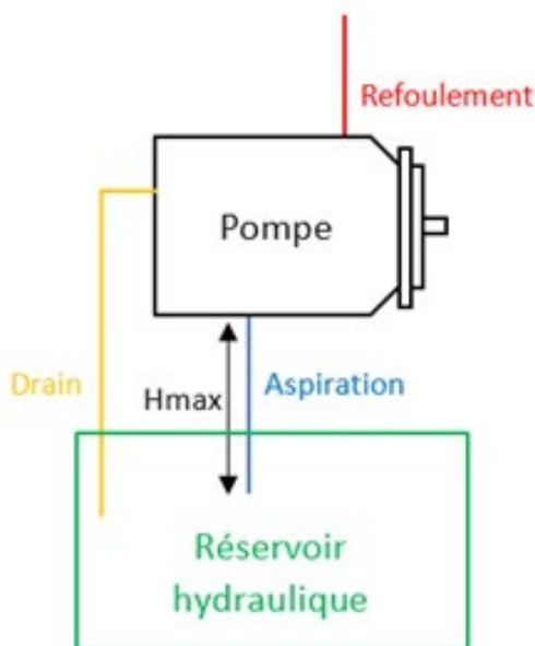
Il faut impérativement veiller, dans ce cas, à **ne pas dépasser la hauteur maximale Hmax de montage** préconisée par le constructeur (hauteur de la tuyauterie d'aspiration).
