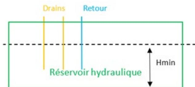
Il est également important de veiller à ce que les conduites de retour et de drainage soient éloignées de la conduite d'aspiration, ce qui permet un repos de l'huile dans le réservoir avant son retour dans le circuit hydraulique (désaération, échanges thermiques, décantation).
