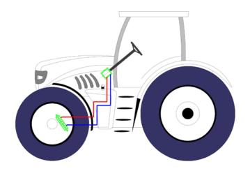
**Le volant** actionné par le chauffeur est **relié au tiroir du distributeur** par la colonne de direction.
