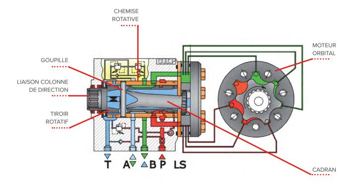
● En synthèse, une action sur le volant entraîne le tiroir, comprime les ressorts, ce qui libère l'huile sous pression vers le moteur orbital. La rotation du moteur permet à la chemise de suivre le mouvement du tiroir. A l'arrêt du volant, la réaction des ressorts permet de refermer totalement la chemise sur le tiroir ce qui coupe le débit d'huile. Le mouvement des roues suit ainsi proportionnellement le mouvement du volant.
