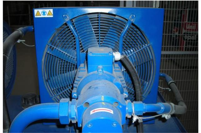
➔ C'est l'huile de retour, donc basse pression, qui passe dans les tubes du radiateur. La vitesse de ventilation agit donc sur le pouvoir réfrigérant.
