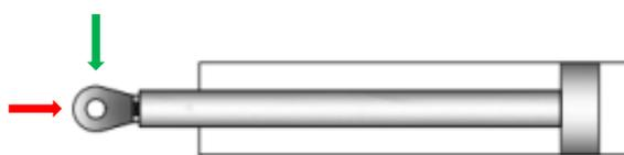
La force axiale s'oppose directement à la sortie de la tige et côté fond la pression va augmenter jusqu'à ce que la tige sorte. On constate que ce vérin possède pour sa tige un certain nombre de guidage : le piston sur lequel elle est fixée, et à l'avant du vérin, le guidage où se trouve les joints d'étanchéité.
