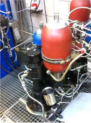
On notera que dans certains cas le rôle du gavage est confié à des accumulateurs, comme sur l'exemple ci-contre avec un montage sur les orifices P et T d'une servovalve travaillant à haute fréquence où les débits instantanés peuvent être très élevés.
